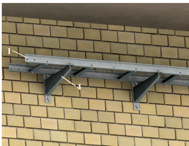
Монтаж на уголках регулируемых к стене вертикально
